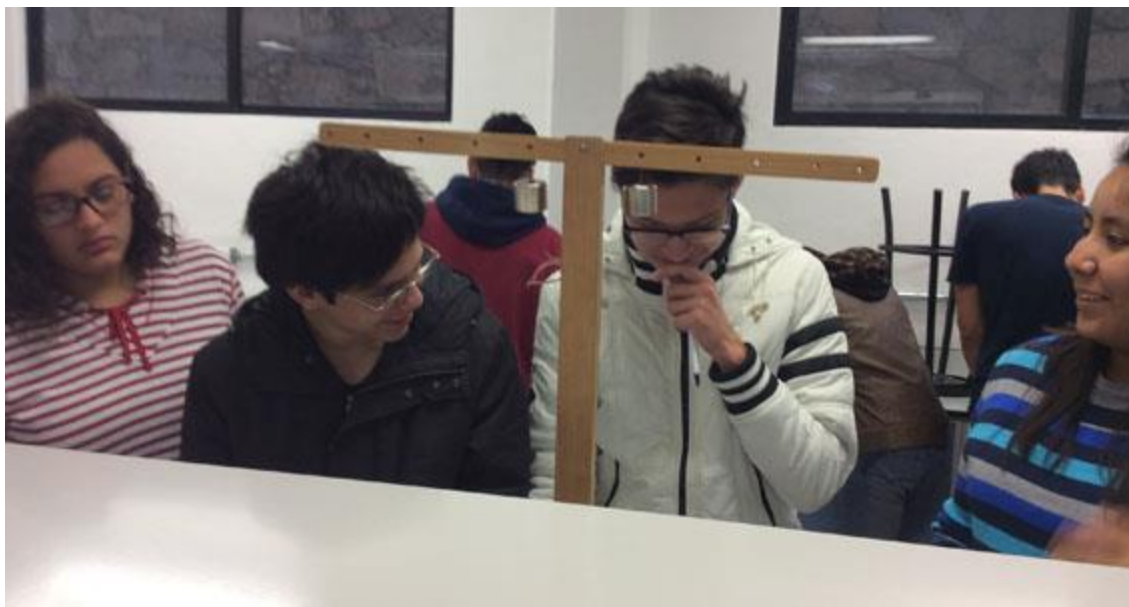
Figura 3. Colocación de las pesas en el lugar correspondiente de la Fisitorca.
