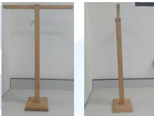
Figura 7. Prototipo experimental didáctico para la comprobación de la Segunda Condición de Equilibrio
